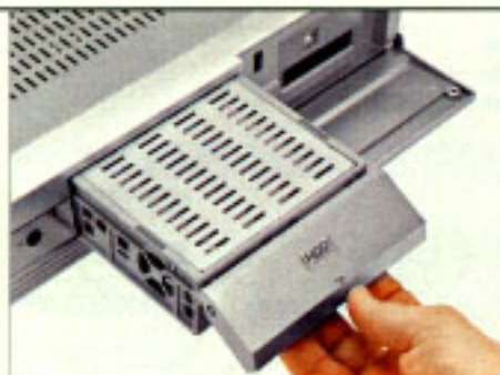
Die Festplatte des „Humax PVR-9100“ lässt sich per Wechselrahmen aus dem Gerät ziehen.
